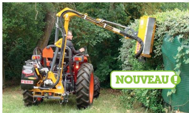
**DÉBROUSSAILLEUSE HYDRAULIQUE INDÉPENDANTE**
