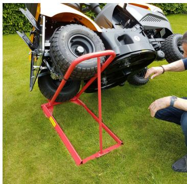
En plus de ne pas être sous l'appareil grâce au basculement latéral, une sécurité automatique et une barre de maintien permettent d'effectuer le nettoyage et l'entretien en sécurité.
