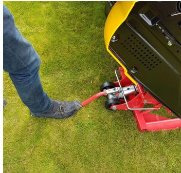
Équipé d'une pédale, le vérin hydraulique permet un basculement sans effort.
